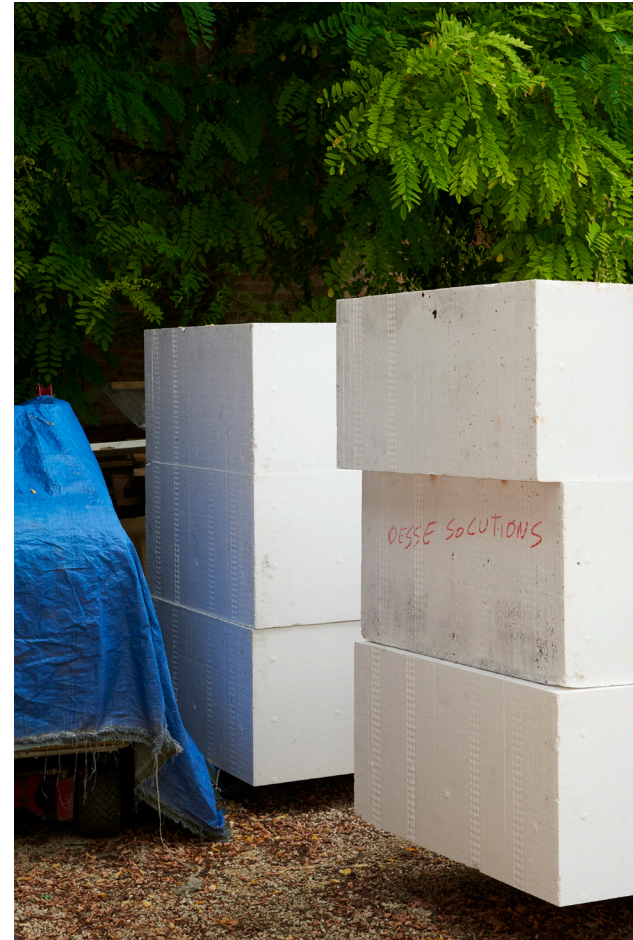
FIG 05. Espuma de poliestireno de muy alta densidad / Very high-density polystyrene foam [Fotografía / Photography Clelia Cadamuro].
