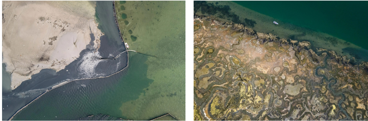
FIG 06. Ocupación de la laguna mediante islas artificiales. Banco de arena artificial construido mediante sedimentos dragados de la vía navegable más profunda de la laguna de Venecia. Foto: Marco Zorzanello National Geographic. https://www.nationalgeographic.es/medio-ambiente/2022/09/salvar-a-venecia-de-las-inundaciones-podria-destruir-el-ecosistema-que-la-sustenta / Occupation of the lagoon with artificial islands. Artificial sandbank constructed using dredged sediments from the deepest waterway in the Venice Lagoon. Photo: Marco Zorzanello, National Geographic. https://www.nationalgeographic.es/medio-ambiente/2022/09/salvar-a-venecia-de-las-inundaciones-podria-destruir-el-ecosistema-que-la-sustenta
