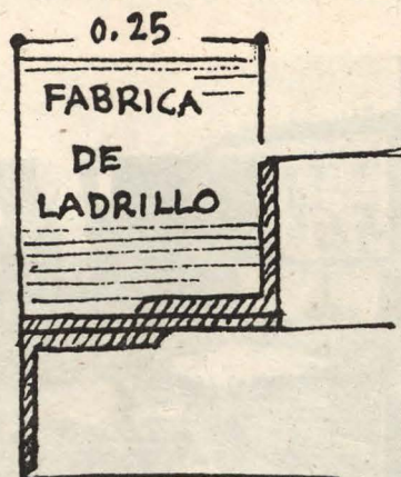
Figuras 7 y 8. Detalles constructivos del pozo indio.
